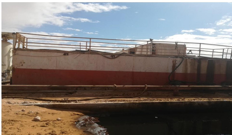
Photo IV.3 : Le skimmer dans le MDZ713 [Photo prise le 07/03/19]
