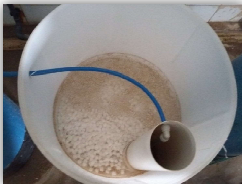
Figure (III.15) : « La cuve de saumurage »
