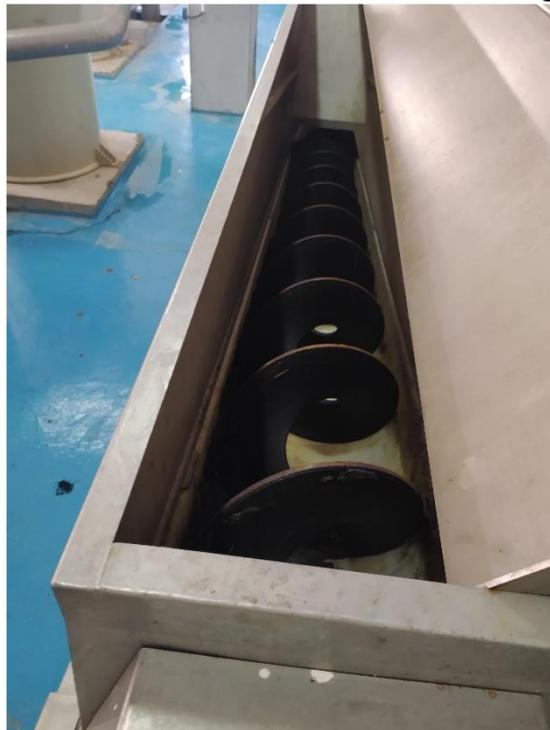
**Figure 3.22.** Vis de convoyage des tables d'égouttage
