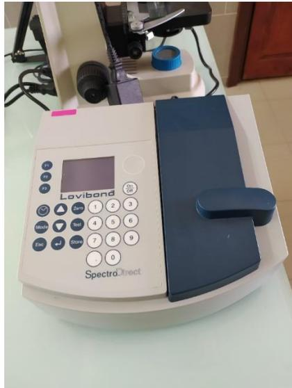
**Figure 4.10.** Spectrophomètre LOVIBOND
