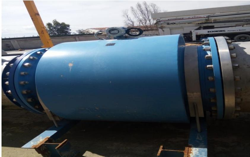
Figure 3.4. Débitmètre électromagnétique
