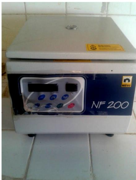
**Figure 15** : centrifugeuse (photo personnelle)
