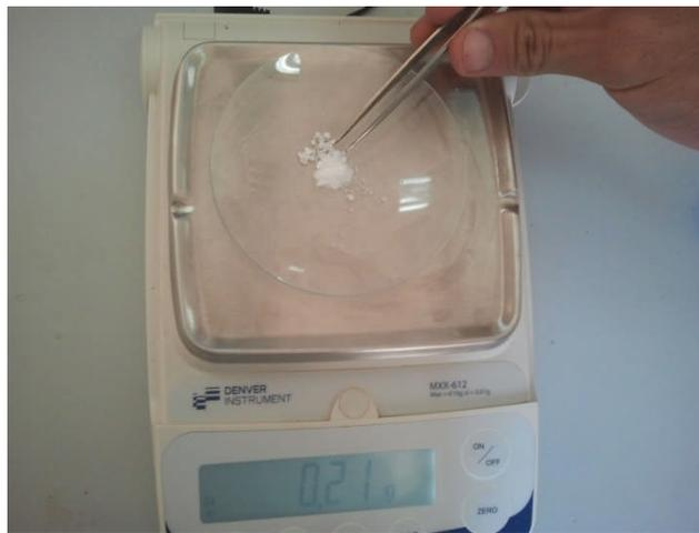
**Figure 16** : Pesée des produits dans une balance à deux chiffres de précision (Cliché personnel).
