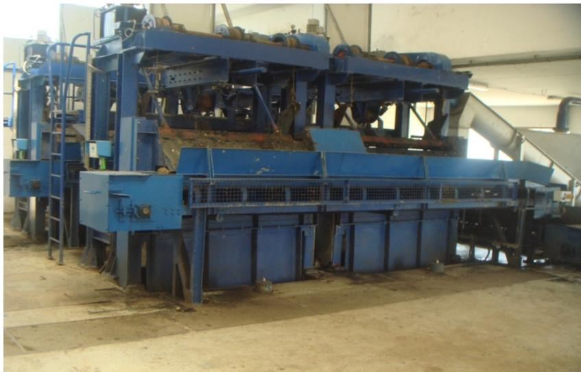
**Figure III.11:** Dégrilleurs mécanique fin et grossier (photo prise sur terrain Mars 2017).
