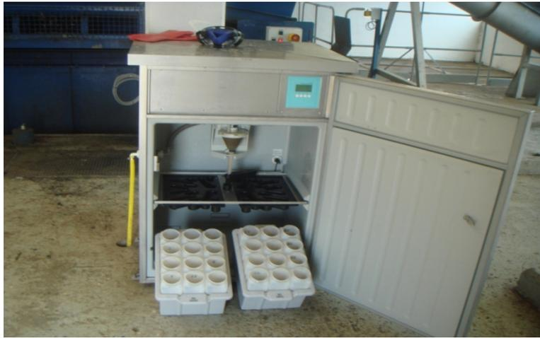
**Figure III.12:** Préleveur d'échantillons automatique à l'entrée (photo prise sur terrain Mars2017).
