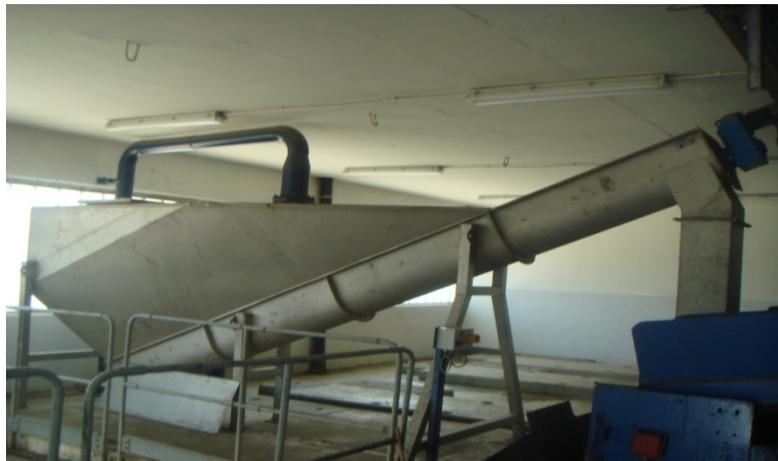
**Figure III.13:** Classificateur à sables(photo prise sur terrain Mars 2017).
