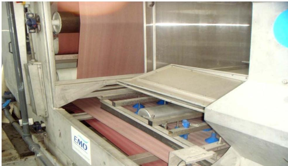
**Figure III.31:** La déshydratation Mécanique par filtre à pression
