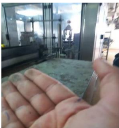
Figure 41 : Présence de poussière et de saleté sur l'ensemble des convoyeurs de bouteilles. (Photographie originale)
