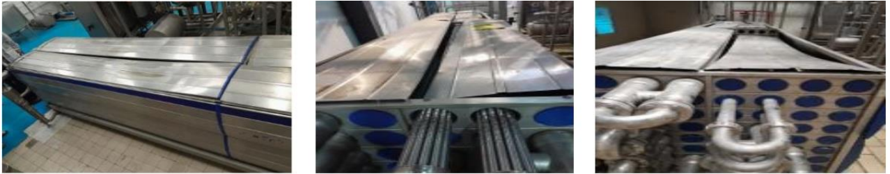
Figure 33 : Les caches des pasteurisateurs TTAD 10000, TTAD 15000 et TTAD 5300 sont déformés et non bien remis à leur place. (Photographie originale)
