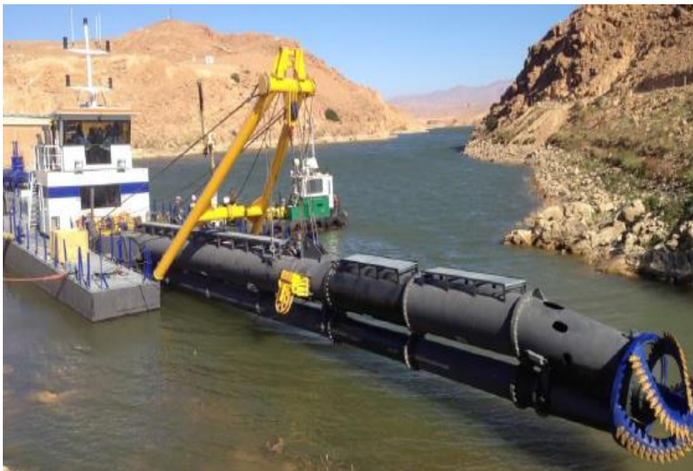
Fig.23 : La drague hydraulique utilisée lors de l'opération de dragageDu barrage de Foum El Gherza.
