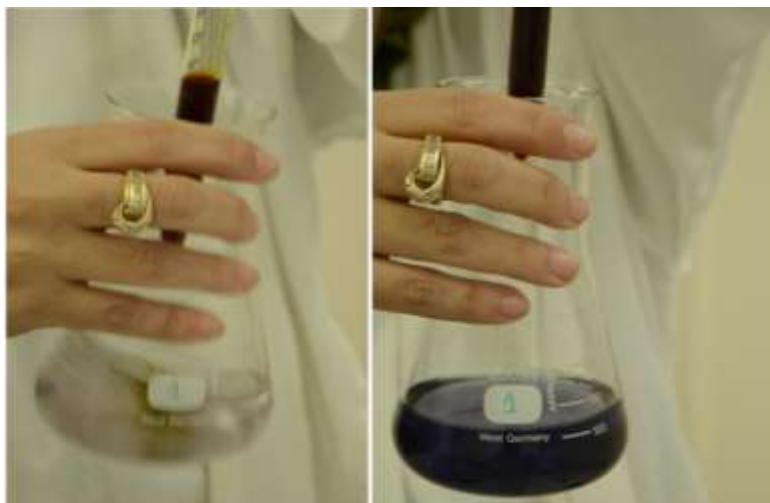
Figure 17 : Titrage par l'iode jusqu'à la coloration bleu-violet
