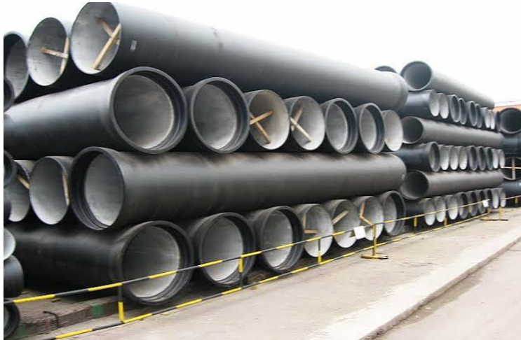
Figure IV20 : Conduites en fonte noire
