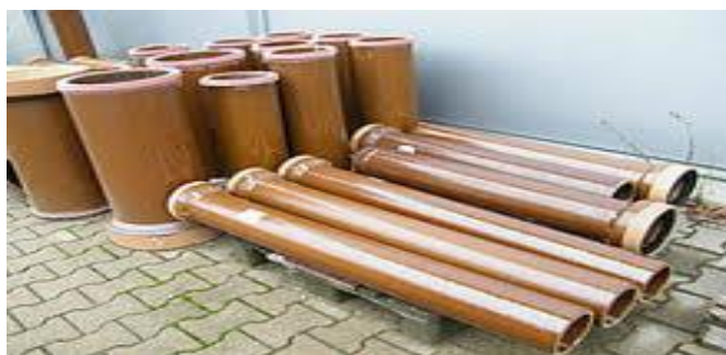
Figure IV 19. Conduites en Grès
