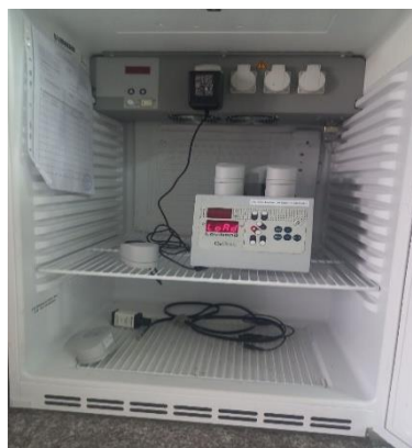
Figure 3.12 : Incubateur et appareil de mesure DBO5 -OxiDirect
