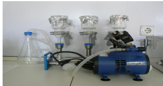
Figure 3.14 : Erlenmeyer, entonnoir gradué et pompe à vide pour la mesure de MES
