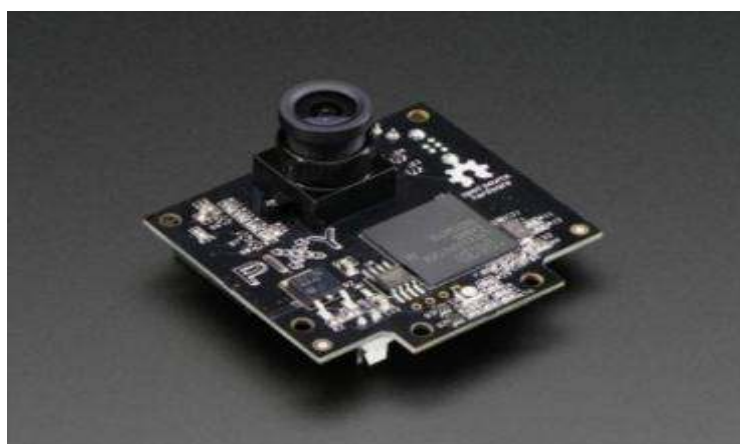
Figure 3.2 Le module pixy cmucam5.
