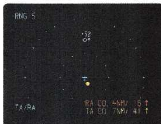
Fig III-18 : Affichage « No Bearing » TA ET RA
