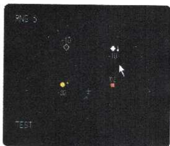
Fig III-70 : motif Test Radar - portée 5 NM Fig III-71 : Motif Test TA/VSI - portée 5NM
