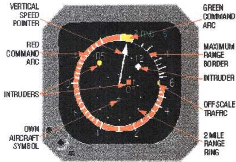
Fig. III-49 : Instrument indicateur de vitesse verticale
