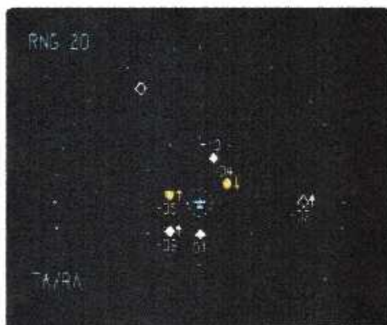
Fig III-16 : Affichage des différents symboles pour les TA et RA
