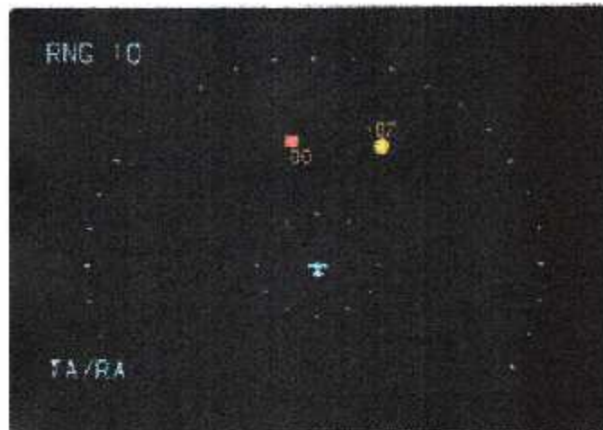
Fig. III-66 : Mode TCAS seulement, même trafic à une portée de 10 miles
