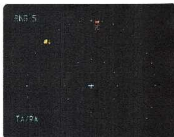
Fig III-17 : Affichage des symboles des TA et RA « circulation hors échelle »
