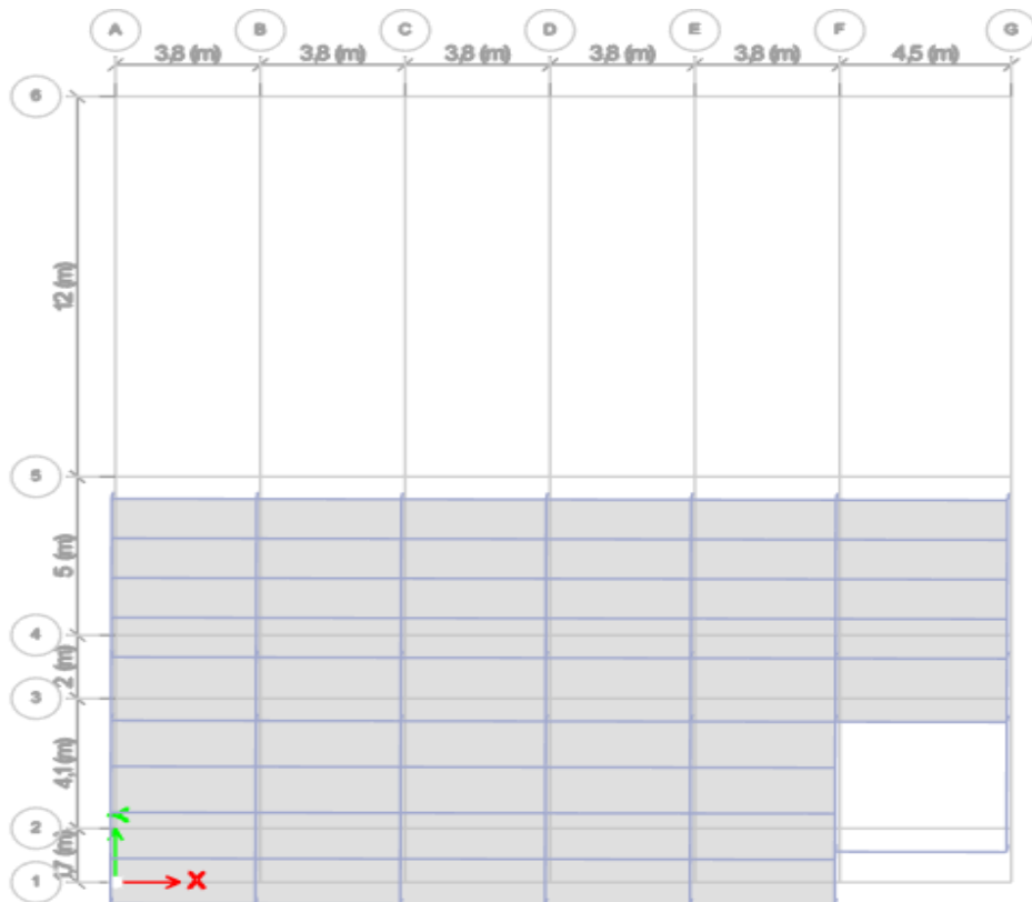
Figure V. 8: Le 2ème mode est un mode de translation suivant y-y.
