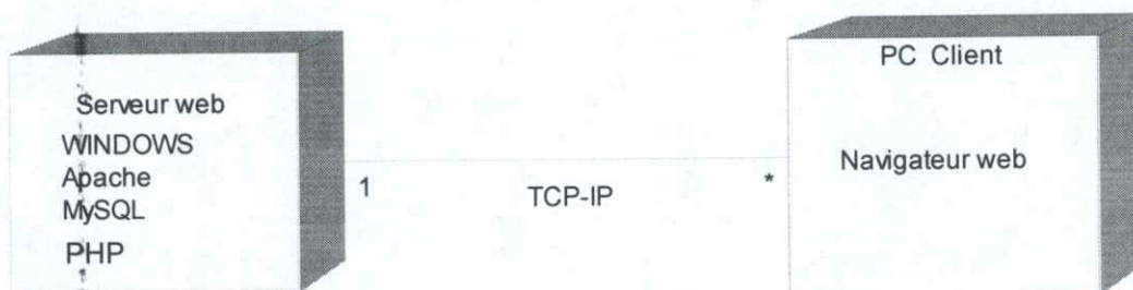
Figure IV.33. Diagramme de déploiement
