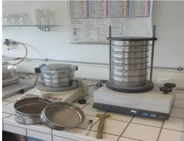
Figure 2.6 : Analyse granulométrique par tamisage.
