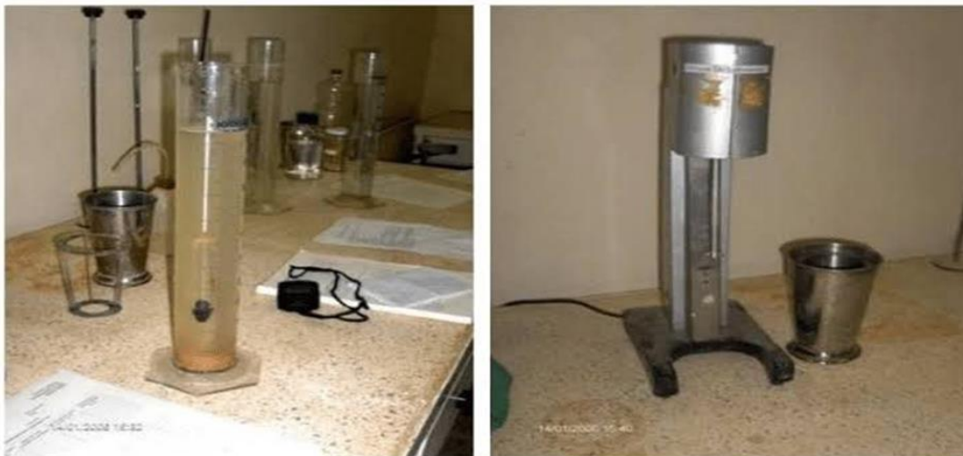
Figure 2.7 : Analyse granulométrique par sédimentaire.
