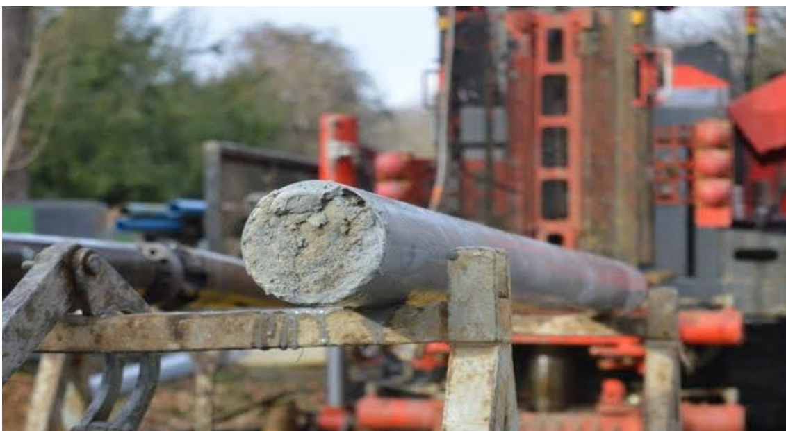
Figure2.5 : Exemple d'une carotte de sol prélevée.
