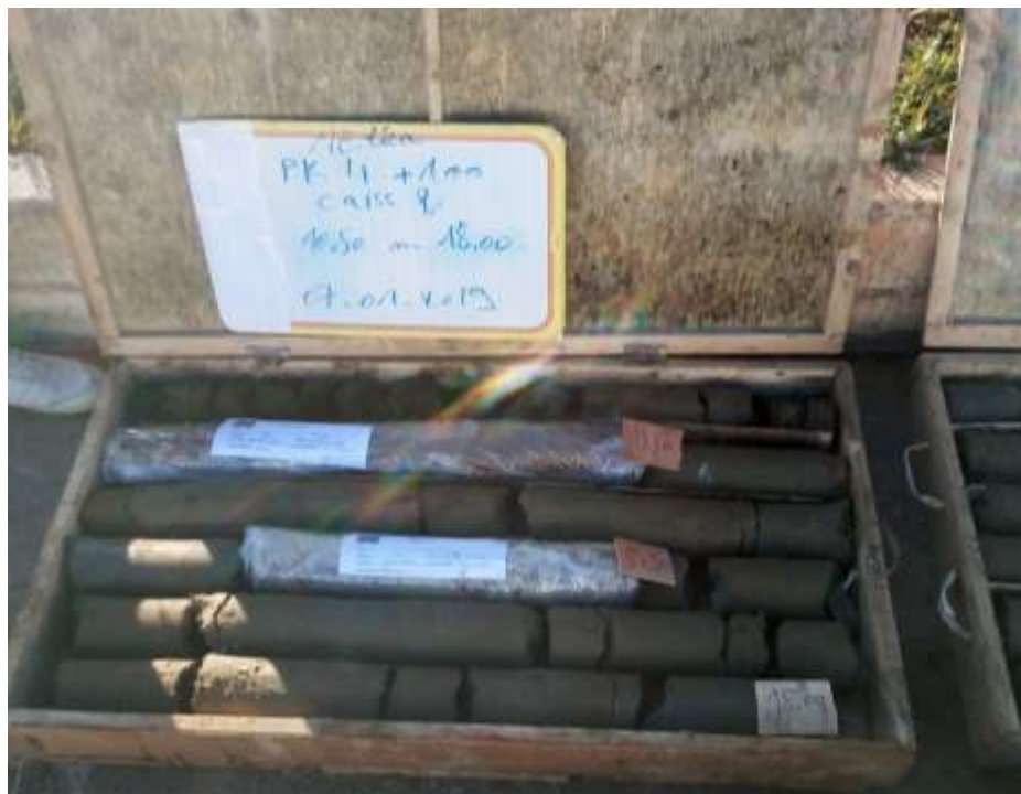
Figure II.7 : Echantillon prélevé du sondage SC01, une profondeur de 10,5 à 18 m [29].
