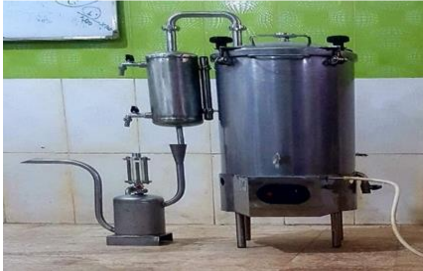
Figure 3.5 dispositif d'extraction des HEs par hydro distillation.
