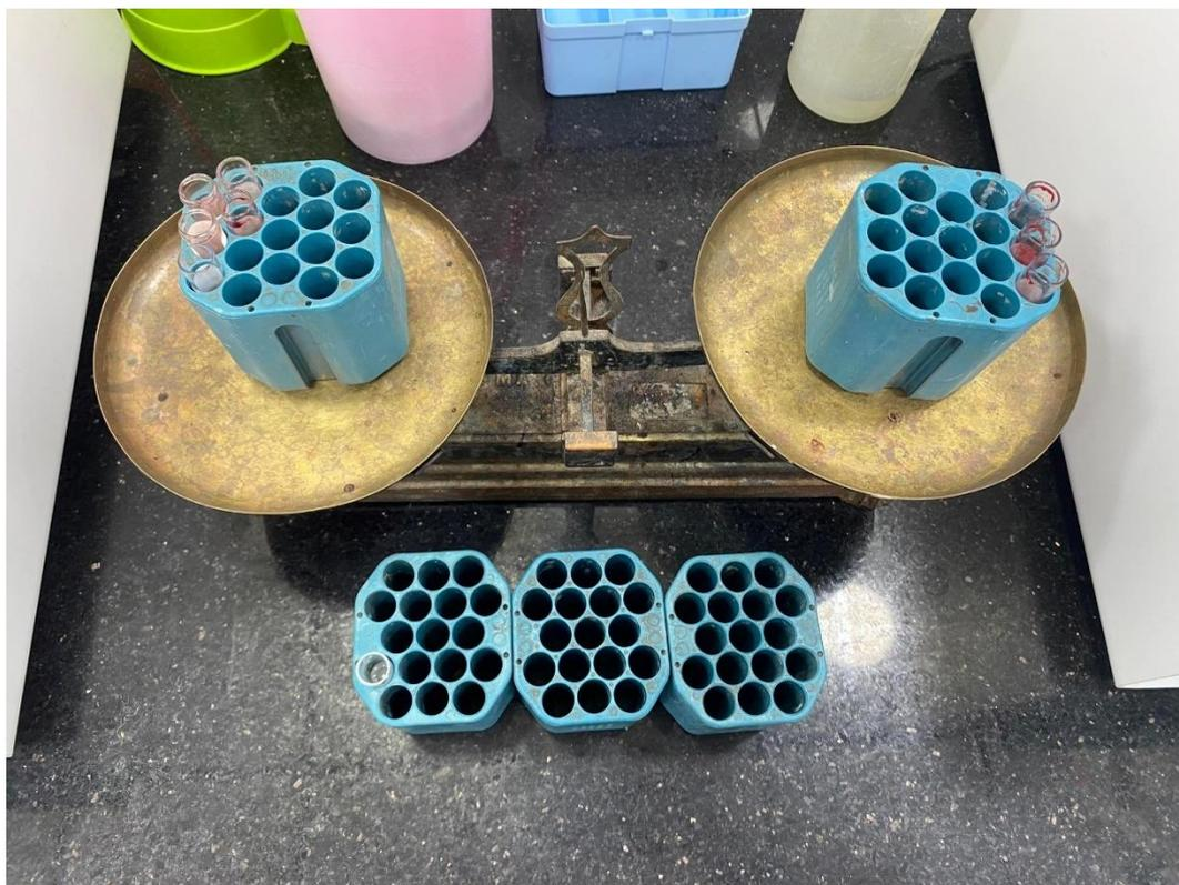
Figure 34 : Balance du type Roberval (photo originale 2023)
