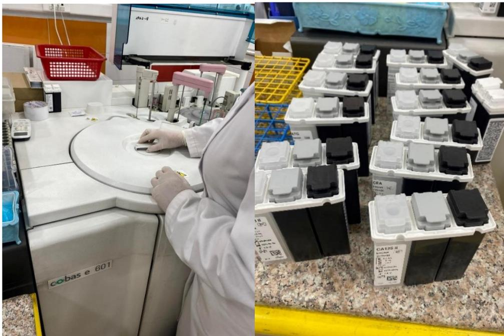
Figure 37 : les réactifs du COBAS e 601 (photo originale 2023).
