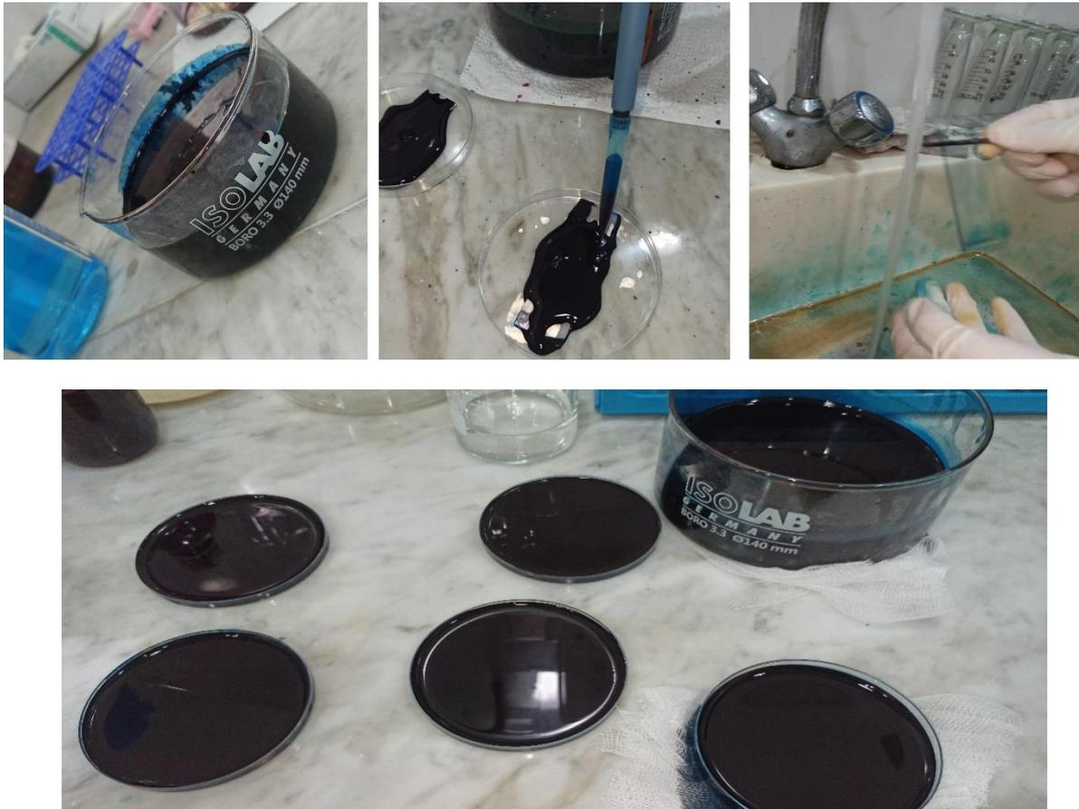
**Figure 16** : coloration au vert de malachite à 5% (photo originale, 2023)
