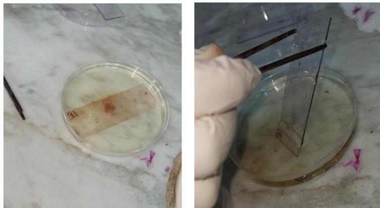
Figure 15 : dépôt des lames dans un bain d'acide sulfurique à 2%. (Photos originale, 2023)
