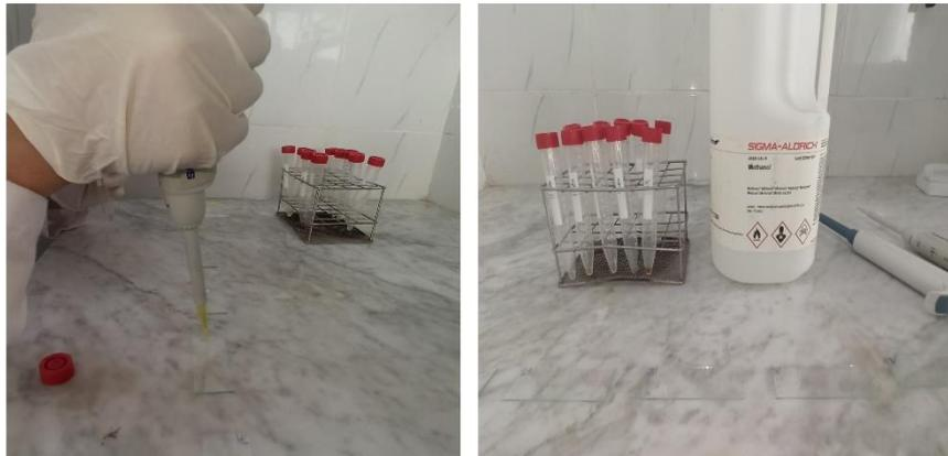
**Figure 13 : Etalement d'une goutte de culot concentré puis fixation par le méthanol.**
