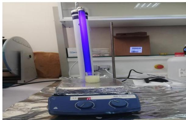
**Figure 2.3 :** Dispositif expérimental du précédé photocatalytique.
