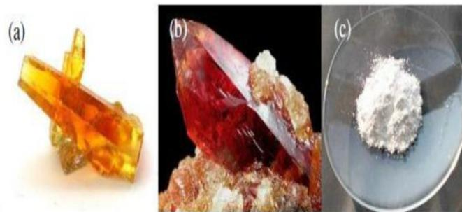
**Figure 1.2.** Oxyde de zinc (ZnO) : (a, b) sous forme naturelle et (c) sous forme artificielle provenant d'une synthèse par précipitation [22].
