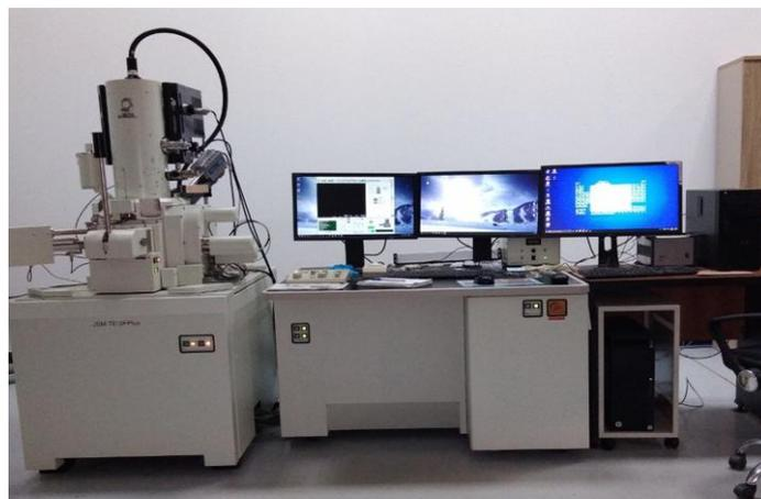
**Figure 2.7 :** Microscope électronique à balayage du CRTSE.
