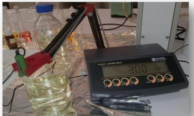
**Figure 2.4 :** Ajustement du pH avec un pH-mètre type HANNA HI 2211.
