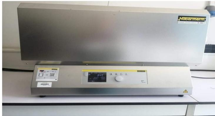
**Figure 2.2 :** Le four tubulaire utilisé pour le recuit des poudres.
