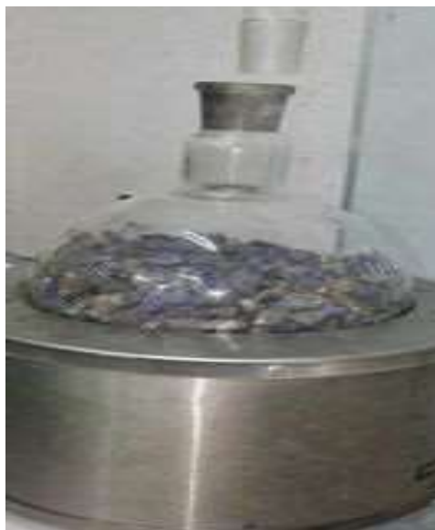
Figure 16 : Chauffer Ballon verre de 2000 ml rempli de Lavandula (Originale 2023)
