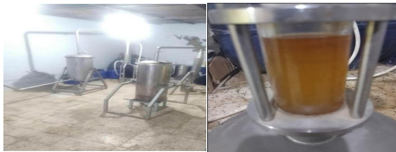
Figure5: Extraction des huiles essentielles par entrainement à la vapeur d'eau ( originale, 2023 )
