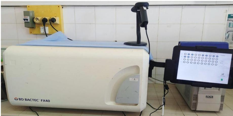
**Figure 2:** BD Bactec FX40 (automate d'incubation et de surveillance des hémocultures).
