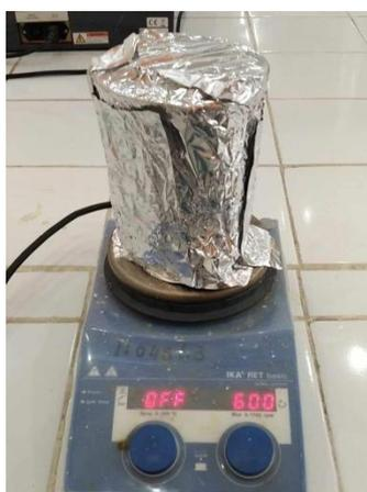
**Figure 6: Agitation mécanique à température ambiante et à l'abri de La lumière.**
