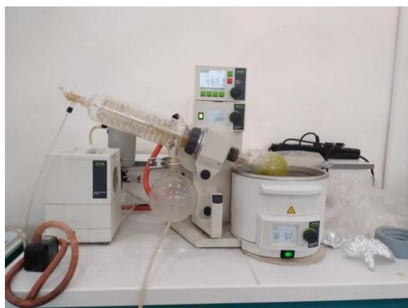
**Figure 5: Evaporation à l'aide d'un Rotavapeur**
