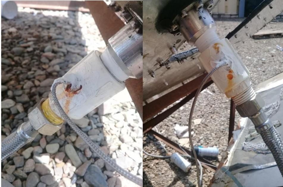
**Figure IV.19:** Emplacement des thermocouples dans les doigts de gants.
