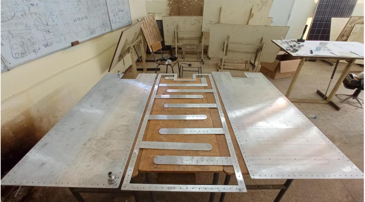
**Figure IV.4** : Les tôles en aluminium (face arrière du capteur, le joint métallique, la face avant du capteur).
