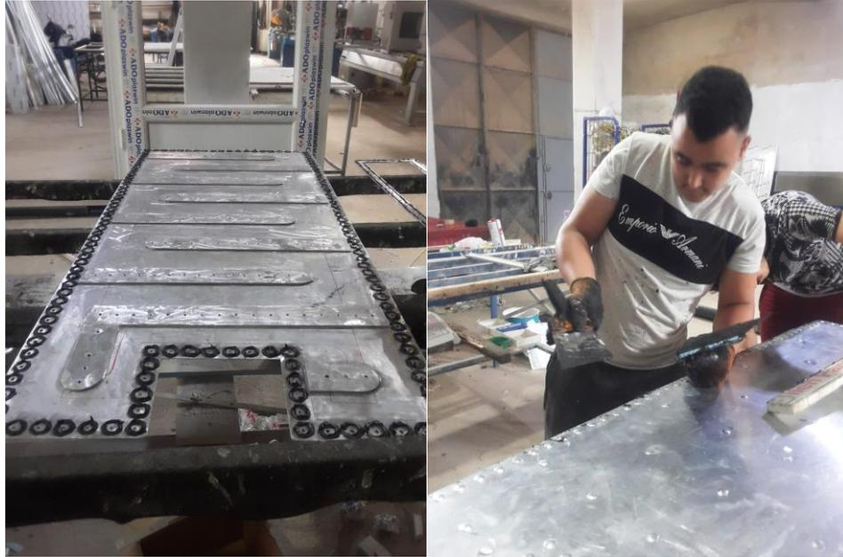
**Figure IV.9 :** Collage et mise du goudron dans les bordures du capteur (TH).
