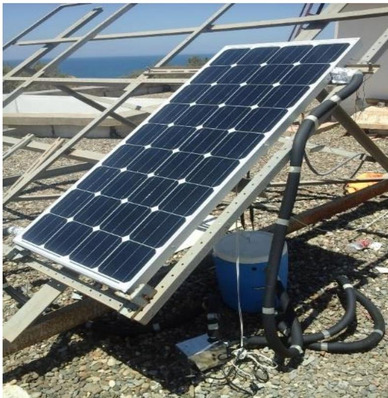
**Figure (I.7) :** capteur PV/THERM avec la cuve de stockage et la pompe. [3]
