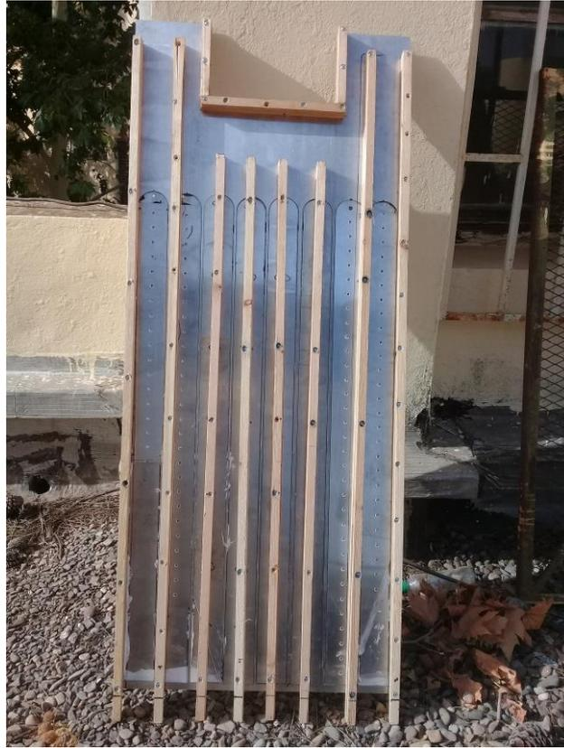
**Figure IV.31 :** vue de la face arrière du capteur thermique à air.
