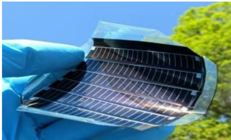
**Figure II.14** : Cellule Tellure de cadmium (CdTe).
