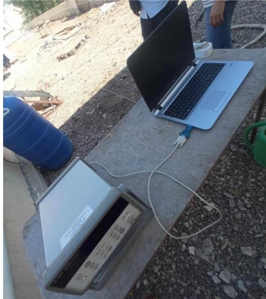
**Figure IV.15 :** Le système d'acquisition de données Agilent 34970A.
