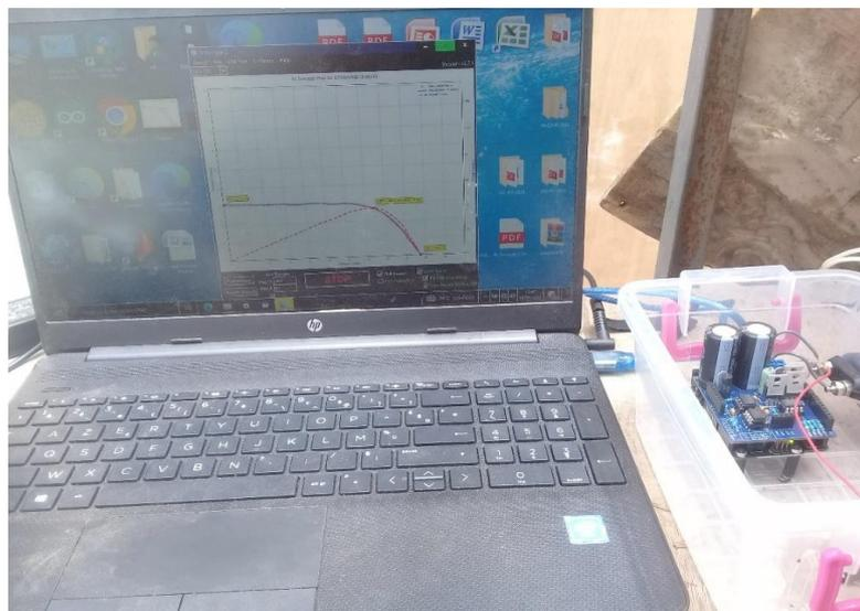
**Figure IV.26:** le traceur I-V connecté avec pc.
