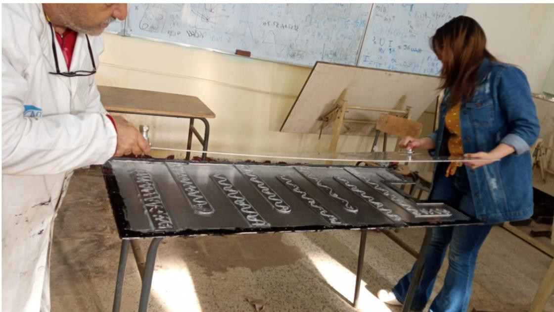
**Figure IV.6:** La mise en sandwich des deux tôles et de joint métallique.
