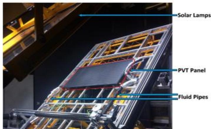
**Figure (I.12) :** Configuration expérimentale dans le laboratoire de simulation solaire de l'Université de Concordia. [8]
