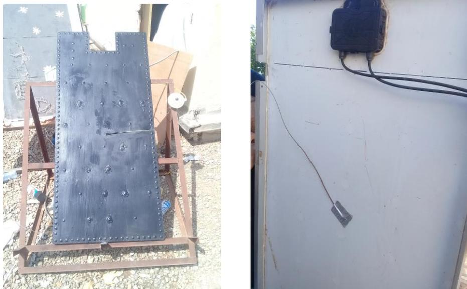
**Figure IV.18 :** Emplacements des thermocouples dans le capteur et le panneau.
