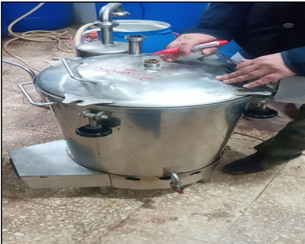
**Figure 06:** Dispositif d'hydrodistillation (Original)
