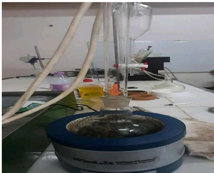
Figure 08 : Montage d'hydro distillation (Clevenger).
