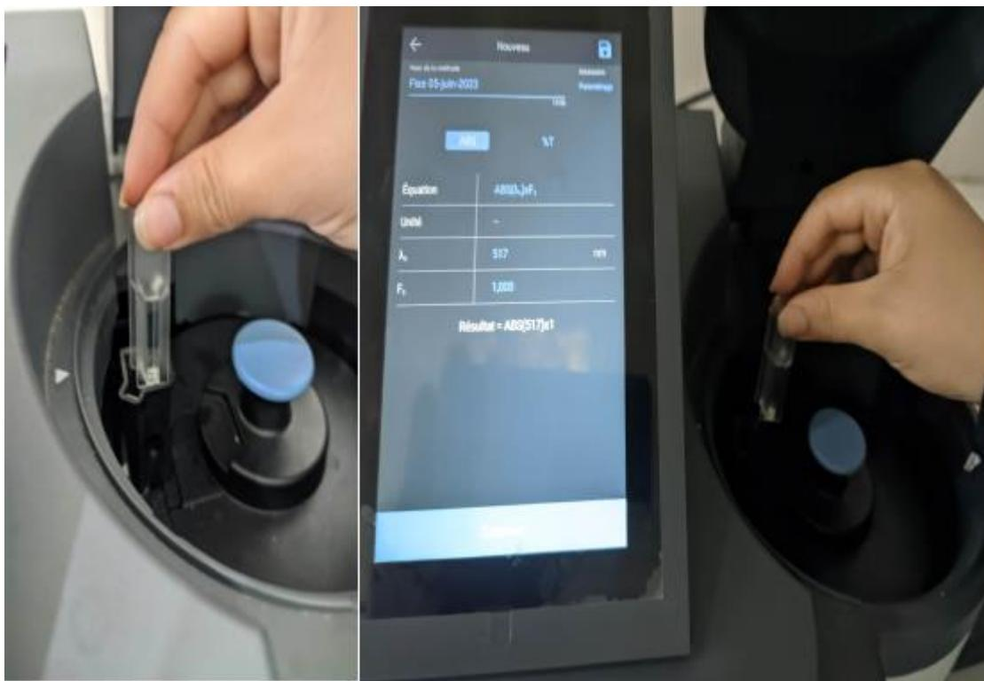
Figure III.2. Spectrophotomètre (517nm).
