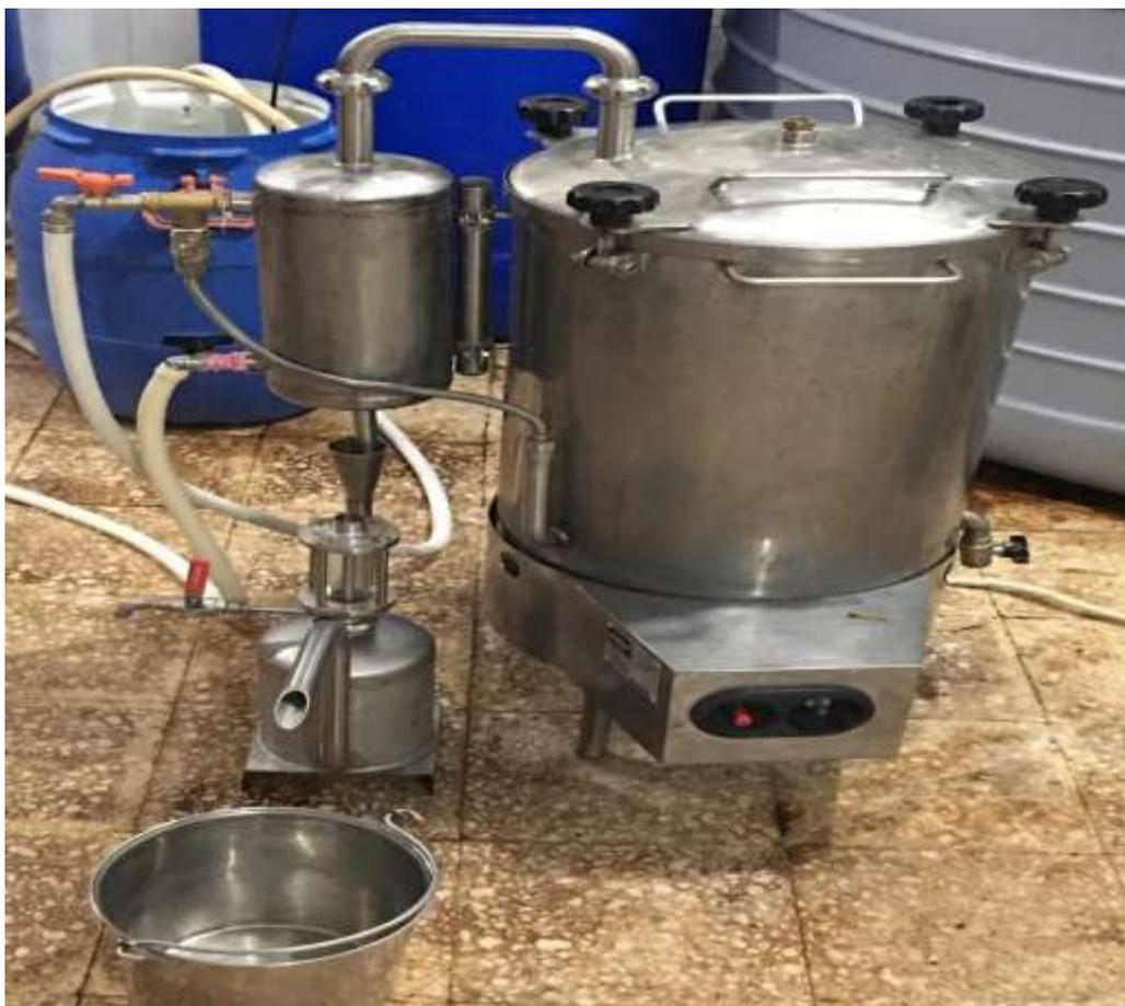
Figure 3.13 : Dispositif d'extraction des HEs par hydro-distillation (Alambic),(photo originale).
