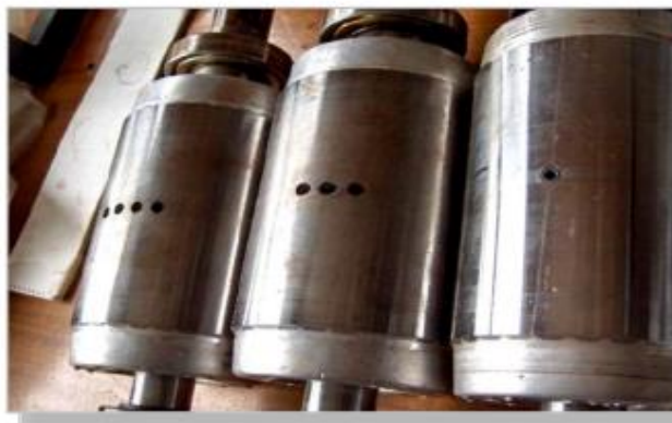
Fig.1.8 Défaut de rupture de barres artificiel
