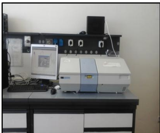
Figure 6 : Spectrophotomètre FT-IR-ATR PERKIN ELMER® couplé au logiciel spectrum two.
