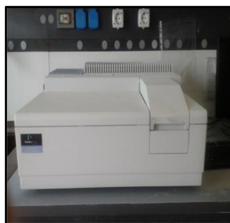
Figure 7 : Spectrophotomètre à UV visible PERKIN ELMER® UV/VIS spectrometer Lambda 25 .
