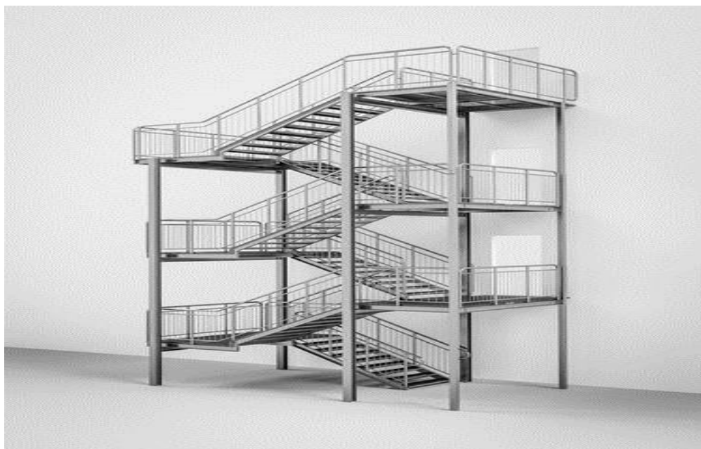
Figure I. 5: Escalier en charpente métallique.
