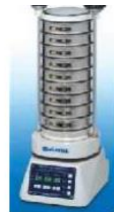
Figure I.5 : Série de tamis à mailles carrées et tamiseuse pour analyse granulométrique.
