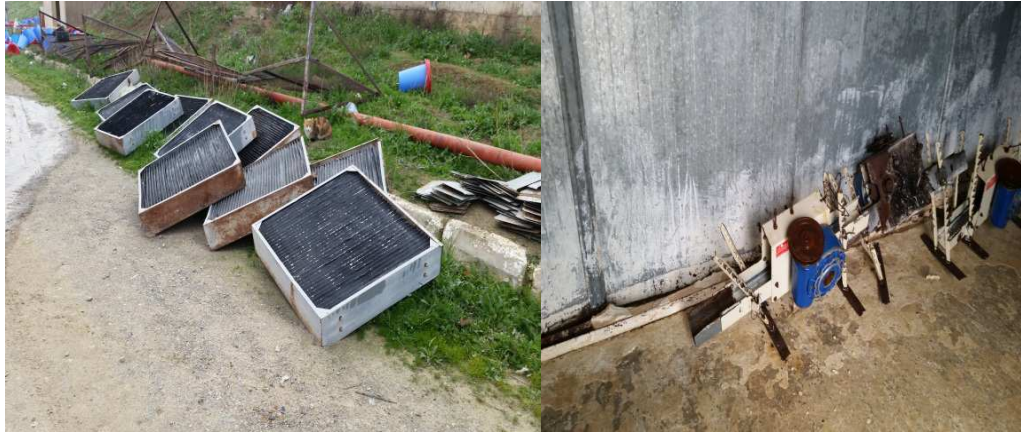
Figures 11: Extracteur et chaîne alimentaire démontés(photo personnelle)
