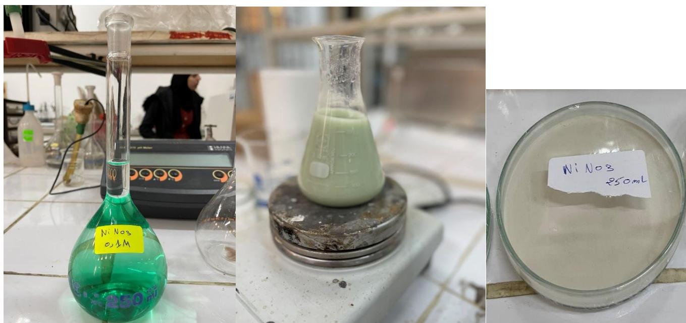
Figure 3.12 : Les étapes de la préparation de la dolomite échangée par \text{Ni}^{2+} .
