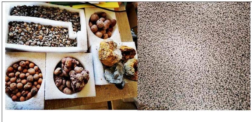
**Figure 8 : Les différentes fractions d'argile expansée.**
