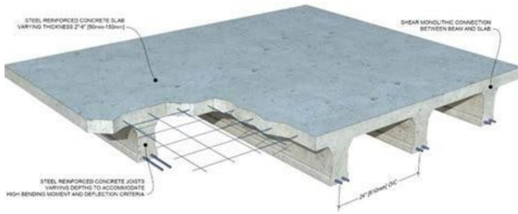
**Figure.II.13** : installation planché nervuré. [17]
