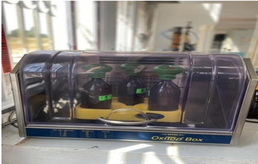
**Figure II.21** : oxitop box pour la mesure de la  $DBO_5$
