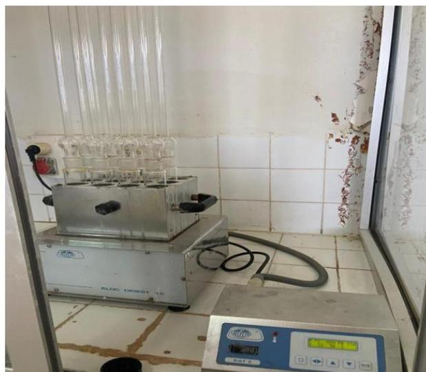
**Figure II.22** : Bloc digest" macro 12 postes pour le dosage de la DCO
