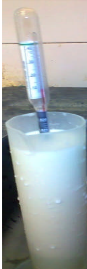
Figure 8 : détermination de la densité de lait cru.
