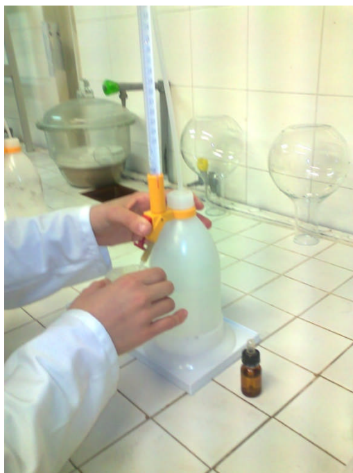
Figure 6 : détermination de l'acidité du lait cru.
