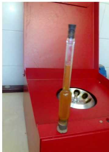
Figure 7 : Détermination de la matière grasse.
