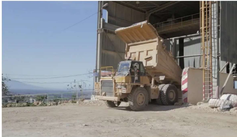
Figure 1-8 : Déchargement du calcaire dans la trémie.
