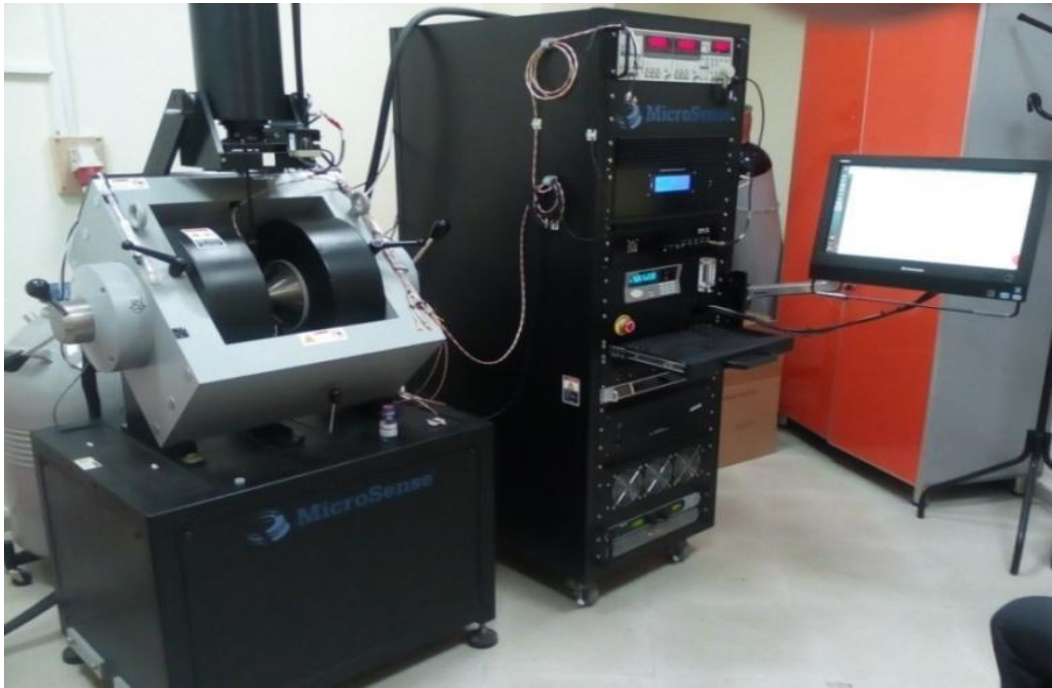
Figure 2.24 : Magnétomètre à échantillon vibrant (VSM) (CRTI).
