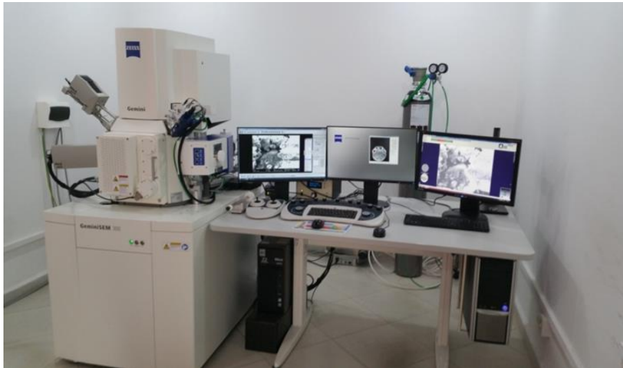
Figure 2.16 : microscopie électronique à balayage (MEB) (CRTI).
