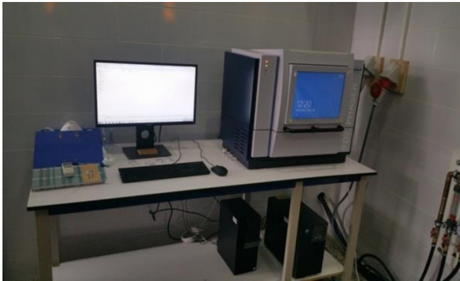
Figure 2.21 : Diffractomètre XPERT PRO de diffraction des rayons X (CRTI).
