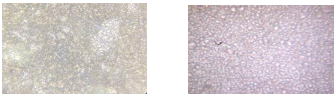
Figure 3.9 : Image microscopique montrant une émulsion H/E des deux crèmes (Optimum « crème cicatrisante BIO » et référence) avec un agrandissement 100.
