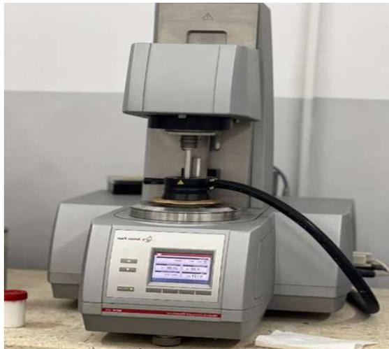
**Figure III .1** : Représente rhéomètre Anton paar
