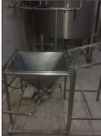
Figure 10 : Tri-Blender servant au mélange des poudres de lait et de l'eau.
