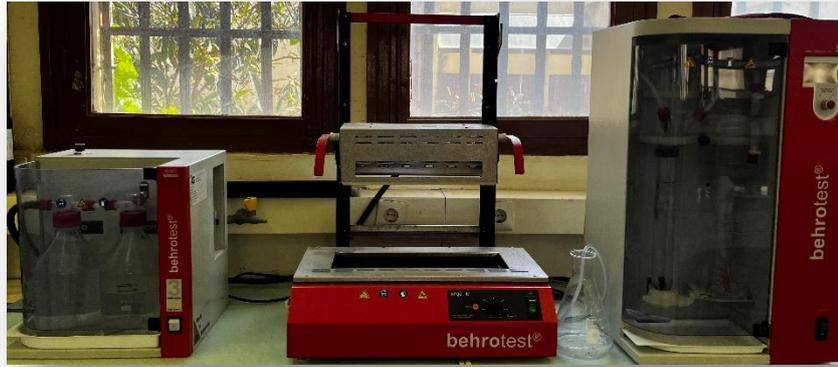
Appareil KJELDAHL (Behr Labor-Tchnik GmbH D-40599 Düsseldorf)
