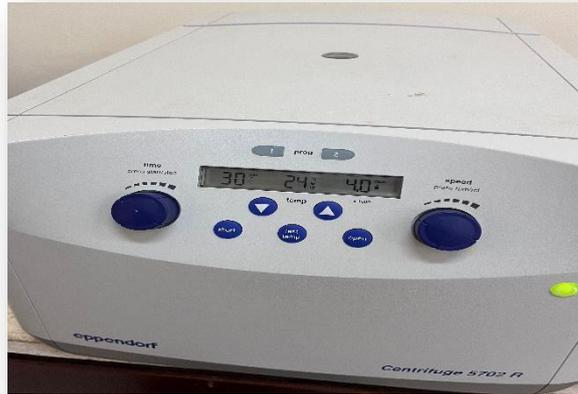
Appareil de centrifugation (Centrifuge 5702 R).
