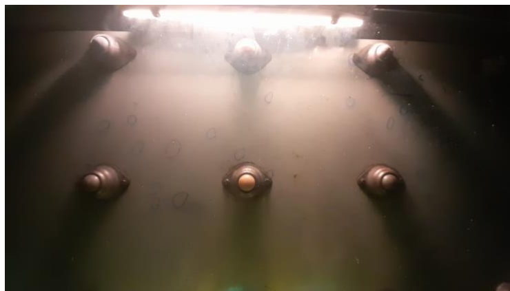
Figure III.2 : Imagerie illustrant les bulles d'affinage par lumière latérale
