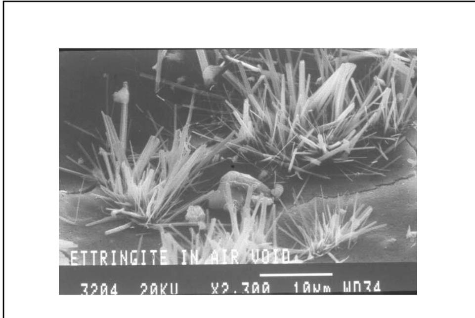
**Figure. I. 8 :** Photo microscopique d'Ettringite
