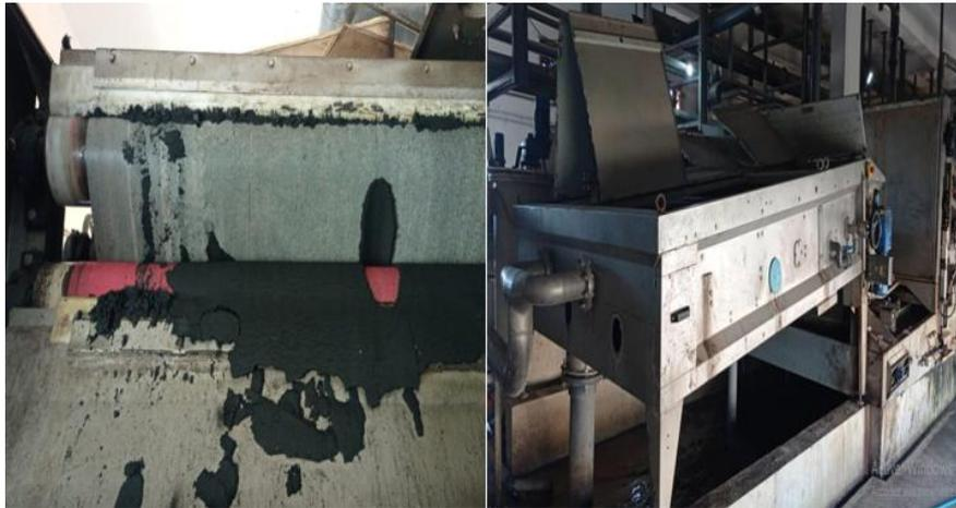
Figure n°31 La déshydratation Mécanique par filtre à pression (Photo prise sur terrain Mars 2024).
