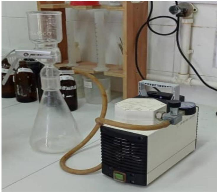
*Figure n° 34 Pompe sous vide (à droite) + rampe de filtration (à gauche).*
