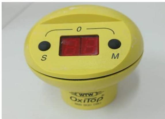
Figure n°38 OxiTop DBO.
