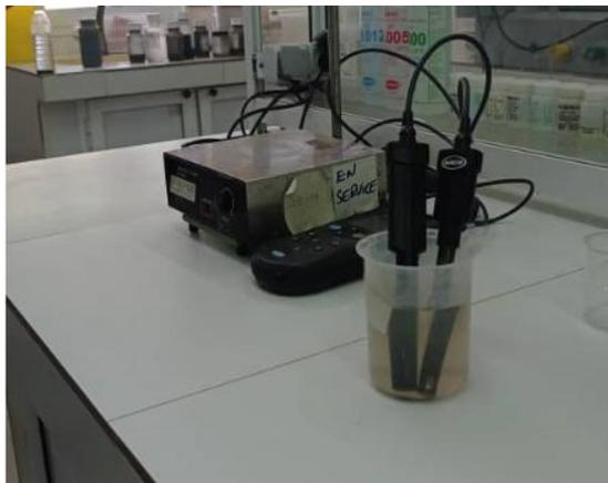
*Figure n°39 Multi paramètres (pH, Conductivité).*
