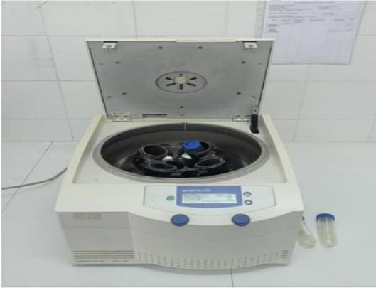
Figure n°35 Centrifugeuse (400tr/min).
