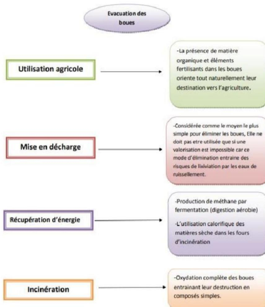
Figure n° 4 Evacuation des boues résiduelles de STEP [44].
