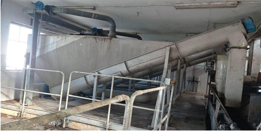
Figure n°16 Classificateur à sables (photo prise sur terrain Mars 2024).
