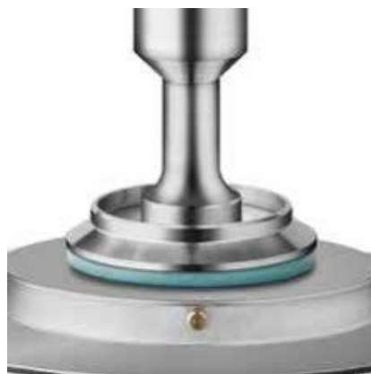
Figure IV.10 : Le système cône plan utilisé pour nos analyses.
