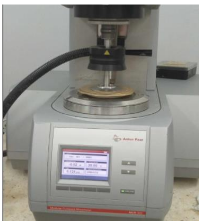
Figure IV.9 : Rhéomètre MCR 302 utilisé pour nos analyses.
